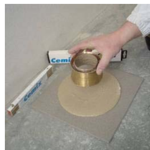
Rozliti materiálu ze zkušební kužele
