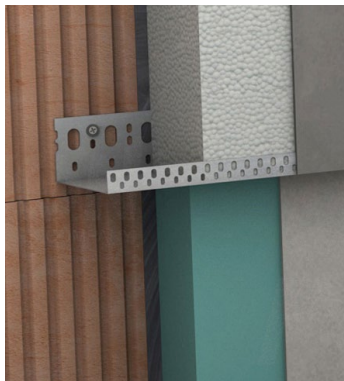
Osazení základací lišty a extrudovaného polystyrenu
