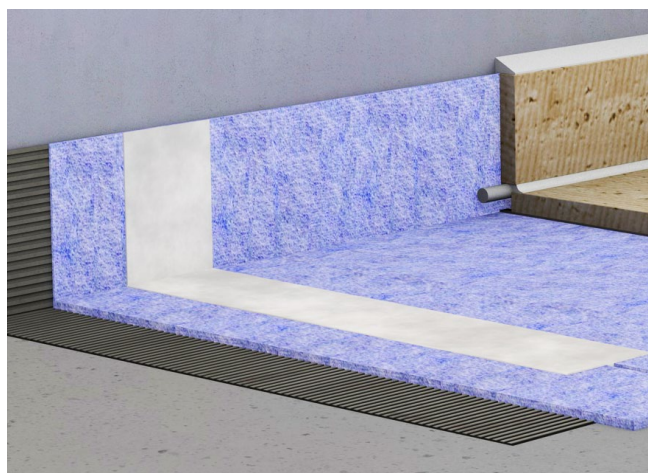
Uložení AQUASTOP MEMBRANE „na tupo“ s přelepením Samolepicím butylovým pásem 150 mm
