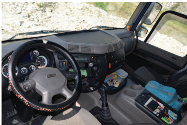
Kabina vychází koncepčně z DAFu, nicméně je posazena výše, a tudíž středový tunel není tak objemný jako u dafů. Je dobře odpružená a vládne v ní ticho
