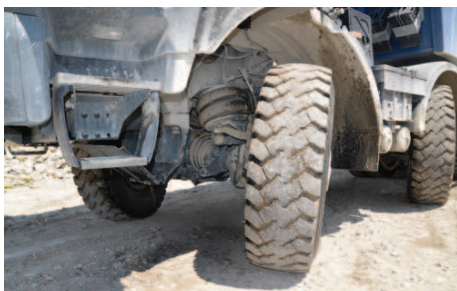
Dva detaily. Nezávislé zavěšení náprav se vzduchovým odpružením (řízeno elektronicky) poskytuje komfort při jízdě i s plně naloženým vozidlem. Zakrytování podvozku chrání jeho komponenty před poškozením
