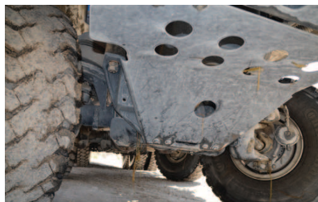
Dva detaily. Nezávislé zavěšení náprav se vzduchovým odpružením (řízeno elektronicky) poskytuje komfort při jízdě i s plně naloženým vozidlem. Zakrytování podvozku chrání jeho komponenty před poškozením
