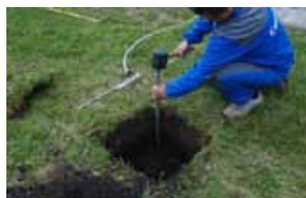
do dna zarazíme tyč, na kterou připevníme metr
