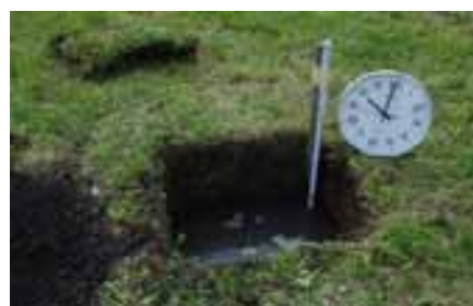
po 30 minutách kontrolujeme pokles hladiny vody
