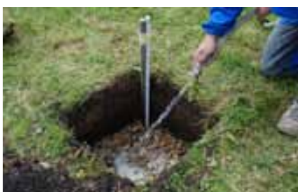
výkop pak naplníme vodou do výše asi 20 cm
