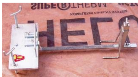
Výškově nastavitelný přípravek s vodováhou (vyrovnávací soupravu tvoří 2 ks)
